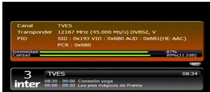
Imagen 39. Potencia de señal en dB.
