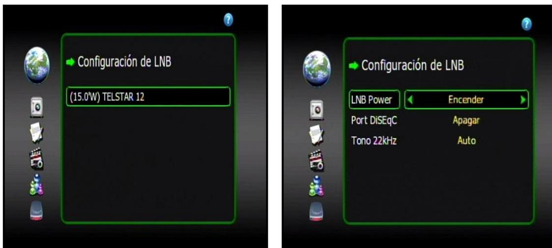
Imagen 34. Configuración de LNB.
