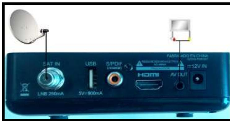
Imagen 31. Conexión video compuesto.
