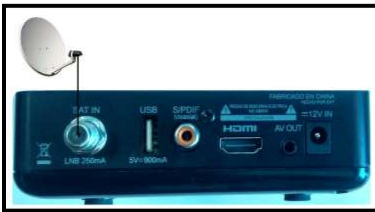
Imagen 29. Conexión a la antena satelital
